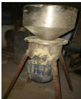
Рис. 2.14. Экспериментальная установка для измельчения сухих корней солодки
